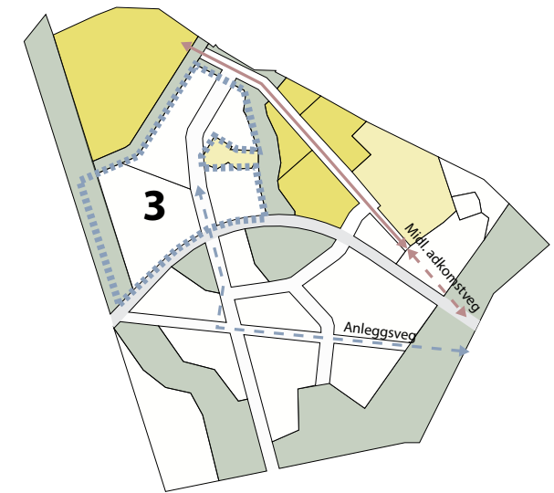
Midlertidig adkomstveg forlenges til nytt felt. Anleggsveg går utenom etablerte boligfelt
