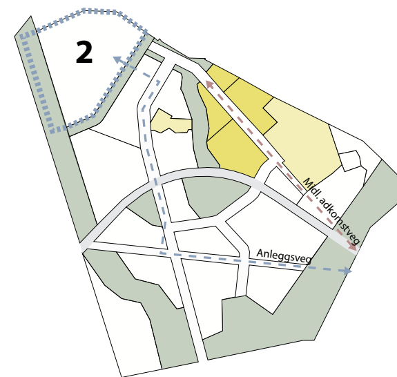
Anleggsveg gjøres om til midlertidig adkomst Ny anleggsveg gjennom eksisterende veger i avstand fra etablert boligfelt
