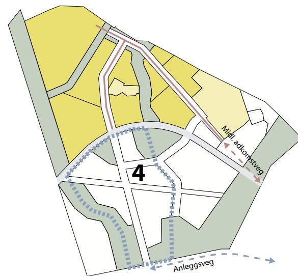
Midlertidig adkomstveg forlenges. Permanent adkomstveg opparbeides.
